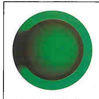
Abb. 10d Fernglas mit P-Belag zwischen zwei parallelen Polarisatoren mit der Dachkante parallel zur Polarisatorachse
